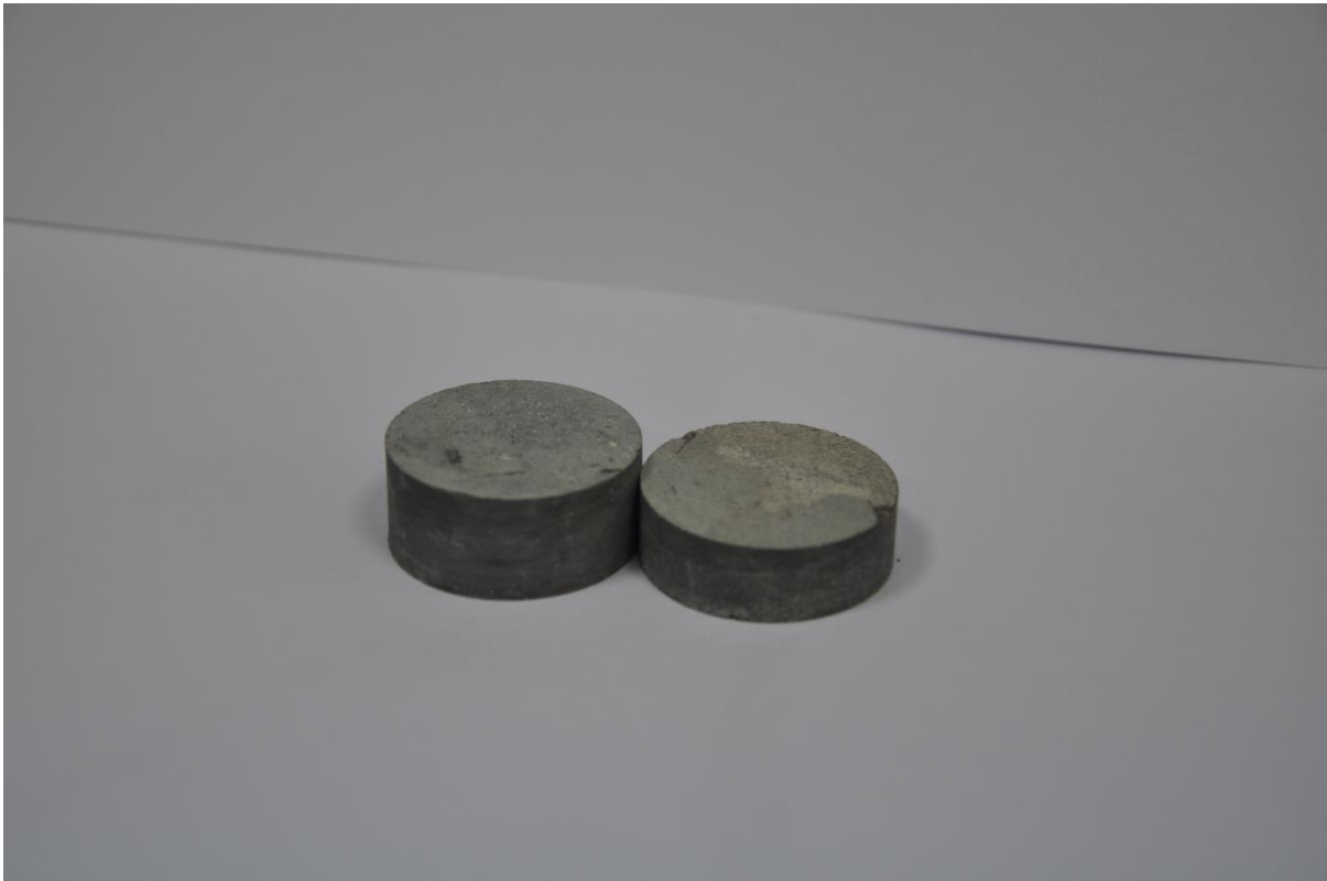
Fig. 1.1.17_206 Widok rdzeni pobranych w strefie nadkładu złoża Nosówka (baden)
