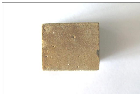
Fig. 1.1.17_113 Próbka kamienia cementowego Nosówka 7 wyjęta z autoklawu po 18 miesiącach deponowania w warunkach wysokiego ciśnienia (20 MPa), wysokiej temperatury (80°C) i CO 2
