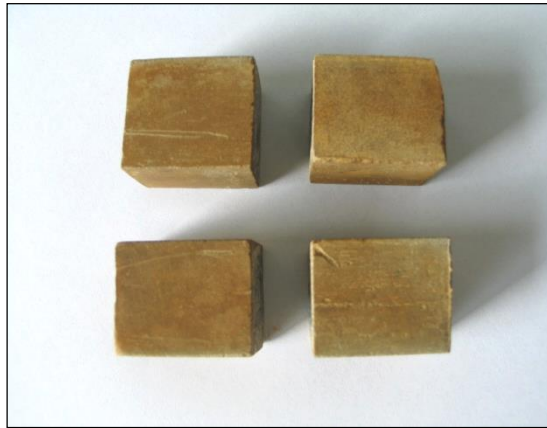
Fig. 1.1.17_237 Próbki kamienia cementowego N-7 wyjęte z autoklawu po 90 dniach deponowania w warunkach wysokiego ciśnienia (20 MPa), wysokiej temperatury (80°C) i CO 2
