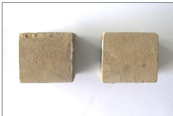
Fig. 1.1.17_110. Próbkę kamienia cementowego Nosówka 7 wyjęte z autoklawu po 12 miesiącach deponowania w warunkach wysokiego ciśnienia (20 MPa), wysokiej temperatury (80°C) i CO 2
