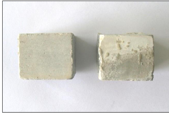
Fig. 1.1.17_115 Próbki kamienia cementowego Pabianice 1 wyjęte z autoklawu po 9 miesiącach deponowania w wodzie w warunkach wysokiej temperatury (70°C) i CO 2
