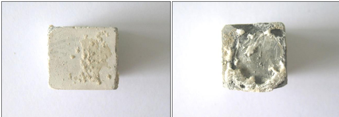
Fig. 1.1.17_116 i Fig. 1.1.17_117 Próbki kamienia cementowego Pabianice 1 wyjęte z autoklawu po 12 miesiącach deponowania w wodzie w warunkach wysokiej temperatury (70°C) i CO 2
