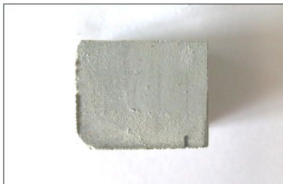
Fig. 1.1.17_121 Próbka kamienia cementowego Paproć 38 wyjęta z autoklawu po 3 miesiącach deponowania w warunkach wysokiego ciśnienia (20 MPa), wysokiej temperatury (70°C) i H 2 O
