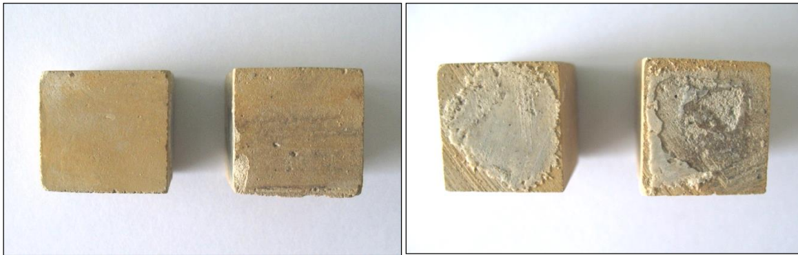
Fig. 1.1.17_111 i Fig. 1.1.17_112 Próbki kamienia cementowego Nosówka 7 wyjęte z autoklawu po 15 miesiącach deponowania w warunkach wysokiego ciśnienia (20 MPa), wysokiej temperatury (80°C) i CO 2
