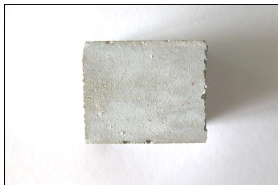
Fig. 1.1.17_114 Próbka kamienia cementowego Nosówka 7 wyjęta z autoklawu po 18 miesiącach deponowania w warunkach wysokiego ciśnienia (20 MPa), wysokiej temperatury (80°C) i H 2 O
