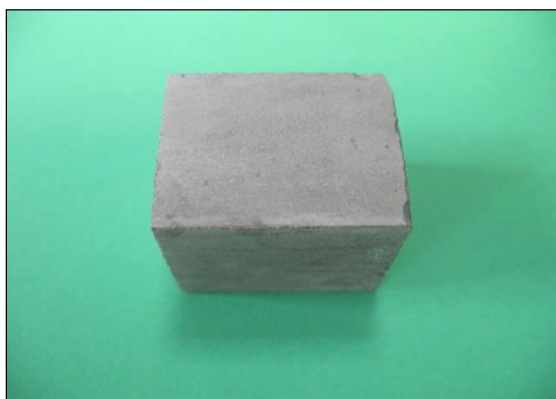
Fig. 1.1.17_234 Próbka kamienia cementowego N-7 użyta do badań (po 28 dniach)
