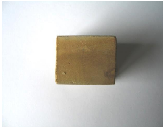
Fig. 1.1.17_240 Próbka kamienia cementowego N-7 wyjęta z autoklawu po 180 dniach deponowania w solance w warunkach wysokiego ciśnienia (20 MPa), wysokiej temperatury (80°C) i CO 2
