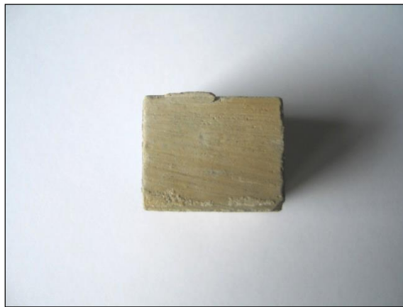
Fig. 1.1.17_245 Próbka kamienia cementowego P-1 wyjęta z autoklawu po 90 dniach deponowania w solance w warunkach wysokiego ciśnienia (20 MPa), wysokiej temperatury (80°C) i CO 2
