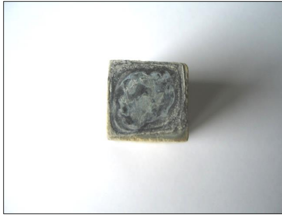
Fig. 1.1.17_244 Próbka kamienia cementowego P-1 wyjęta z autoklawu po 90 dniach deponowania w solance w warunkach wysokiego ciśnienia (20 MPa), wysokiej temperatury (80°C) i CO 2
