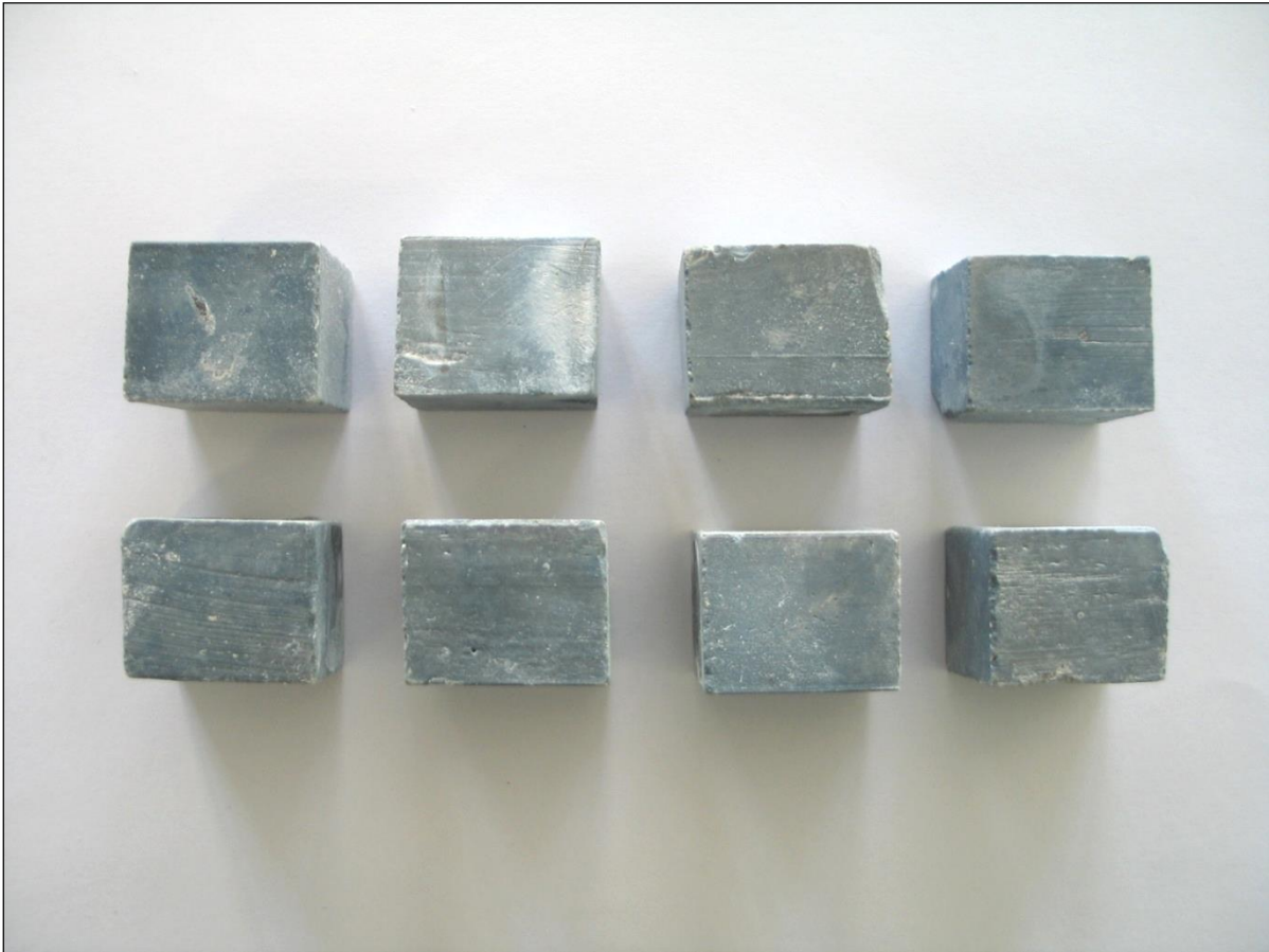
Fig. 1.1.17_242 Próbkki kamienia cementowego P-1 użyte do badań (po 28 dniach)
