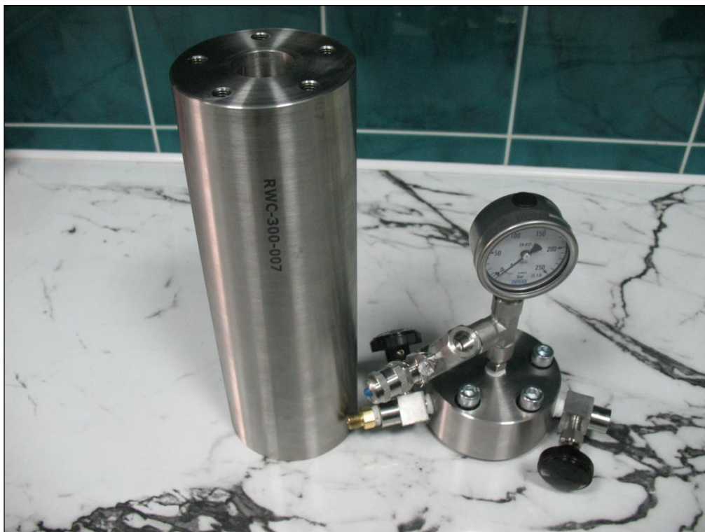
Fig. 1.1.17_232 Autoklaw do przechowywania próbek kamieni cementowych w środowisku CO 2
