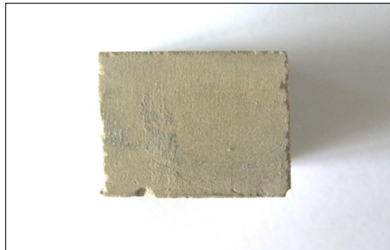
Fig. 1.1.17_120 Próbka kamienia cementowego Paproć 38 wyjęta z autoklawu po 3 miesiącach deponowania w warunkach wysokiego ciśnienia (20 MPa), wysokiej temperatury (70°C) i CO 2
