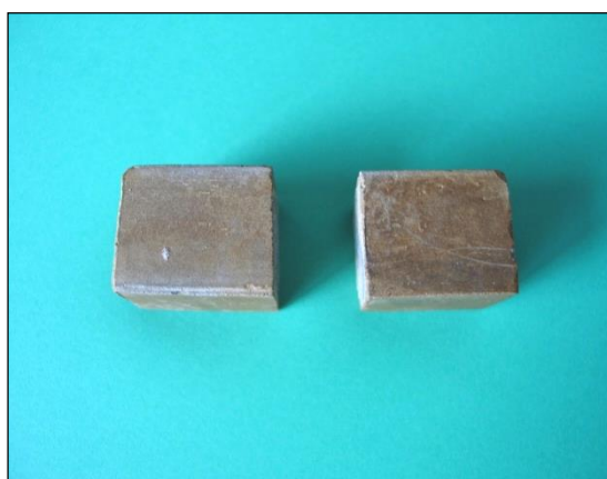
Fig. 1.1.17_235 Próbki kamienia cementowego N-7 użyte do badań (po 28 dniach)
