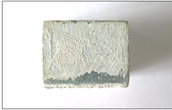
Fig. 1.1.17_119 Próbka kamienia cementowego Pabianice 1 wyjęta z autoklawu po 15 miesiącach deponowania w wodzie w warunkach wysokiej temperatury (70°C) i H 2 O
