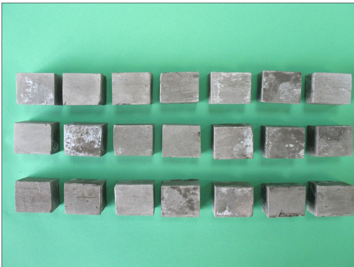
Fig. 1.1.17_233 Próbki kamienia cementowego N-7 użyte do badań (po 28 dniach)
