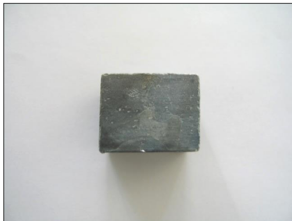
Fig. 1.1.17_246 Próbka kamienia cementowego P-1 przechowywana w solance w temp. 70°C i ciśnieniu 0,1 MPa po 90 dniach.
