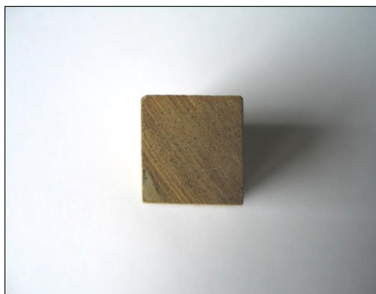
Fig. 1.1.17_239 Próbka kamienia cementowego N-7 wyjęta z autoklawu po 180 dniach deponowania w solance w warunkach wysokiego ciśnienia (20 MPa), wysokiej temperatury (80°C) i CO 2
