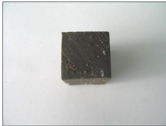
Fig. 1.1.17_241 Próbka kamienia cementowego N-7 przechowywana solance w temp. 80°C i ciśnieniu 20 MPa po 180 dniach
