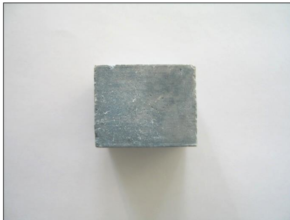
Fig. 1.1.17_243 Próbkka kamienia cementowego P-1 użyta do badań (po 28 dniach)
