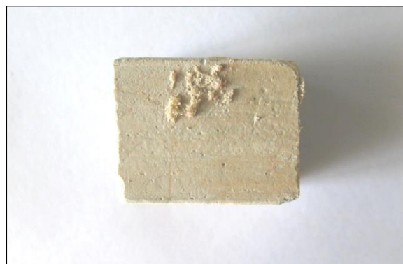
Fig. 1.1.17_118 Próbka kamienia cementowego Pabianice 1 wyjęta z autoklawu po 15 miesiącach deponowania w wodzie w warunkach wysokiej temperatury (70°C) i CO 2
