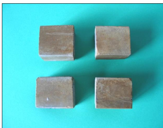
Fig. 1.1.17_236 Próbki kamienia cementowego N-7 użyte do badań (po 28 dniach)
