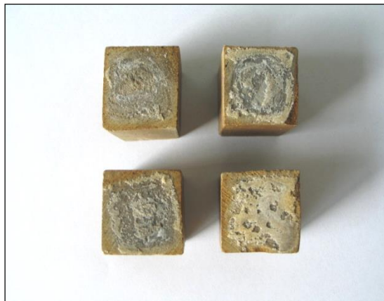
Fig. 1.1.17_238 Próbki kamienia cementowego N-7 wyjęte z autoklawu po 90 dniach deponowania w solance w warunkach wysokiego ciśnienia (20 MPa), wysokiej temperatury (80°C) i CO 2
