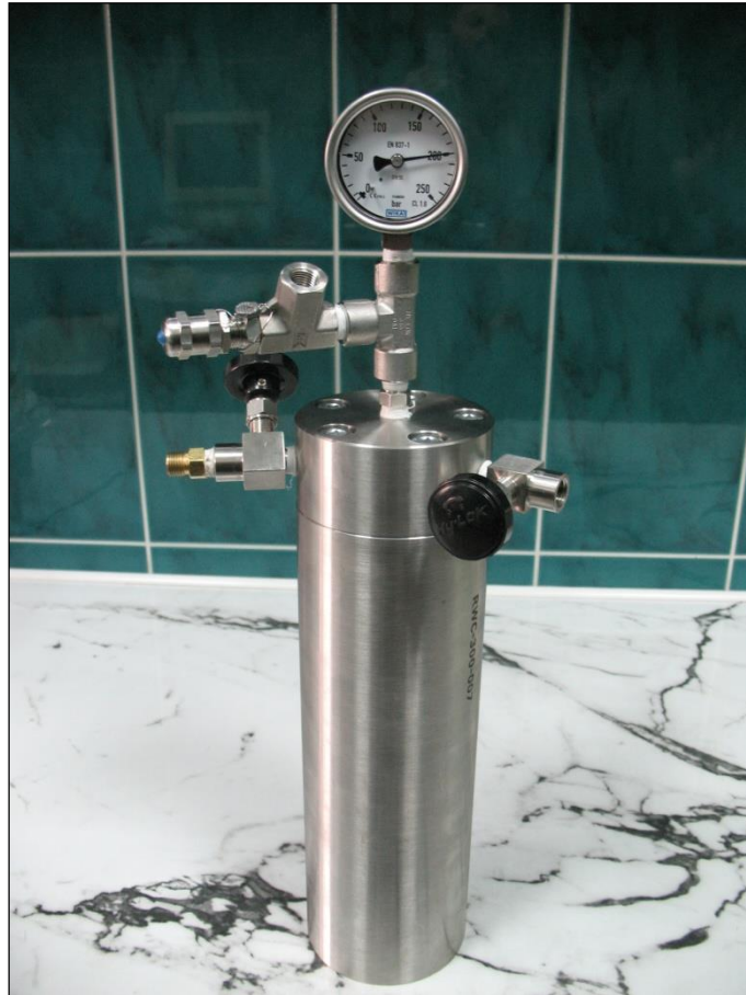
Fig. 1.1.17_230 Autoklaw z próbkami kamieni cementowych nasyconych CO 2 pod ciśnieniem 20 MPa
