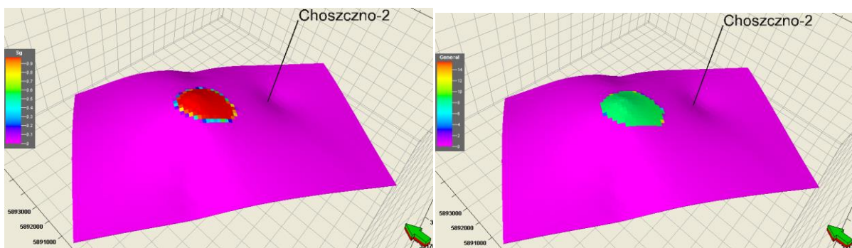
Fig. 1.1.16_254 Rozkład nasycenia swobodnego CO 2 (po lewej) oraz rozpuszczonego CO 2 (po prawej) w warstwie stropowej uszczelnienia toarku po 25 latach zatłaczania
