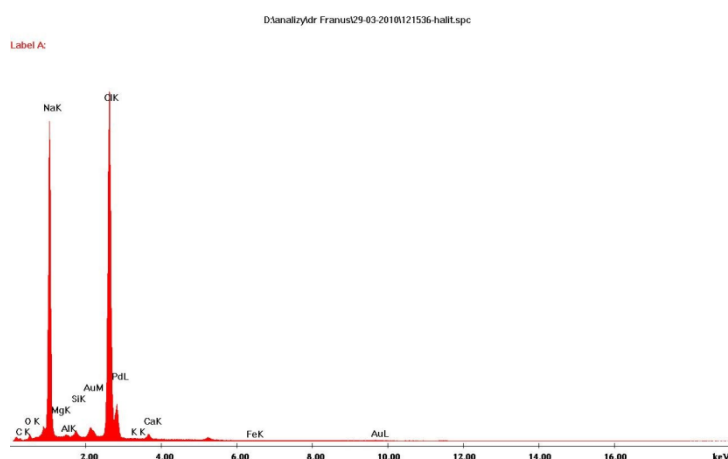
Fig. 1.1.14_110 Widmo EDS halitu zaobserwowanego w próbce piaskowcowej W12-1536
