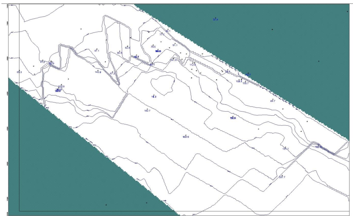
Fig. 1.1.9_32 Rozkład ciśnień piezometrycznych w modelu - warunki pierwotne.
