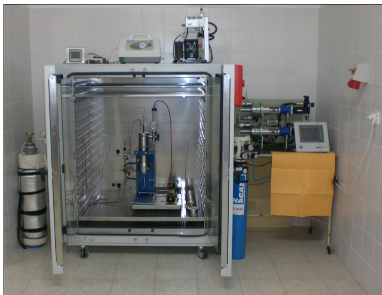
Fig. 1.1.7_57 Widok stanowiska do badania ciśnienia progowego skał
