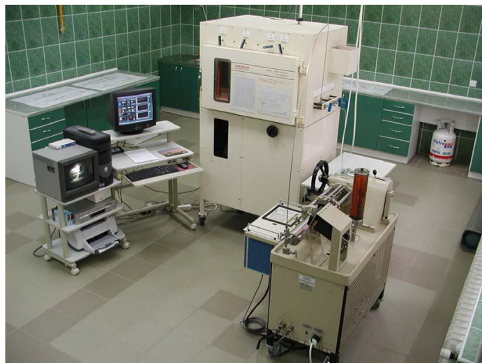
Fig. 1.3.2_8 Aparatura do badań PVT firmy Chandler Engineering „Model 2370-300-GT PVTSystem”
