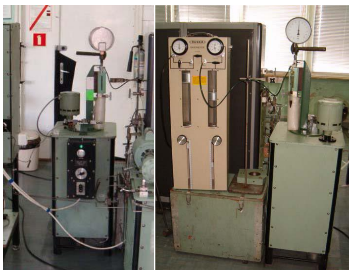
Fig. 1.3.2_10 Zestaw badawczy typu „slim tube” (Nodzeński i in., 2005)
