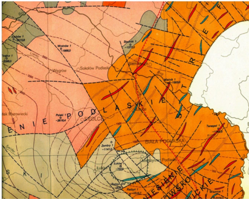
Fig. 1.1.1_44 Fragment mapy strukturalnej powierzchni stropowej prekambryjskiego podłoża krystalicznego, pokazujący plan strukturalny i lokalne struktury korzystne dla potencjalnego składowania CO 2 (według Kubickiego, Ryki, 1982)
