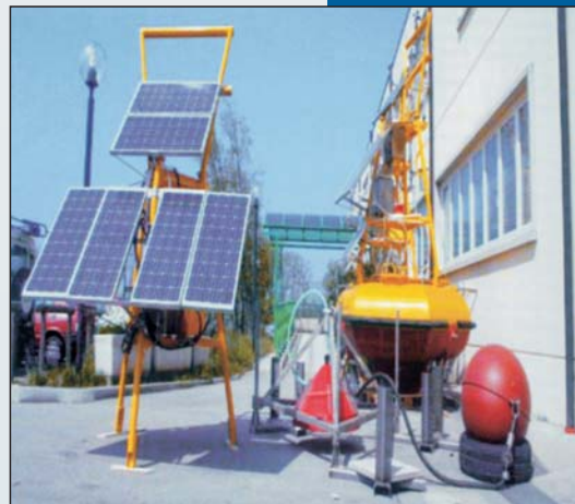
Rycina 2 Boja monitorująca z panelami słonecznymi jako źródło energii, pływaki i aparaty służące do pobierania próbek gazu z dna oceanu
